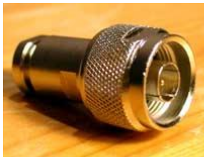
Złącze N męskie (wtyk) na kabel H-155 skręcane
