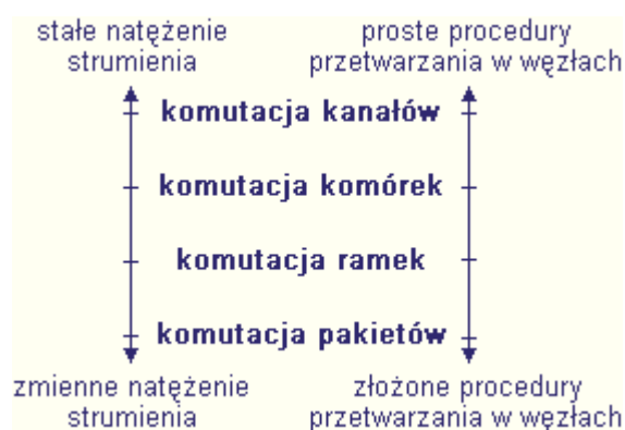
Rys.2.2. Uporządkowanie technik komutacji
