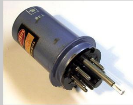
2K45(Raytheon) termicznie regulowany klistron refleksowy; przedział częstotliwości: 8.5-9.66 GHz, średnia moc wyjściowa: 30 mW.
