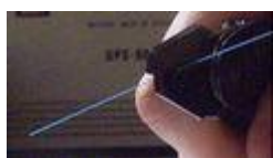
Rys. 20. Zdrapywanie ostatniej warstwy ochronnej
