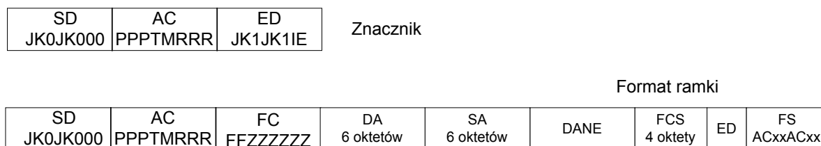
Rysunek 3.20 Format znacznika i ramki w sieci IBM Token Ring
