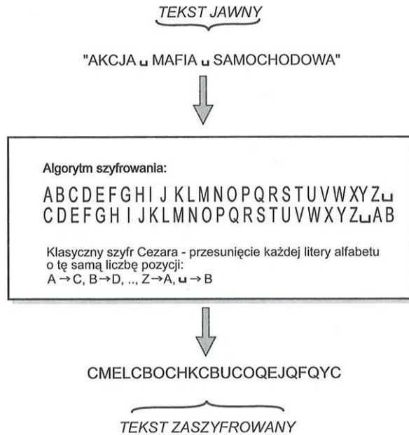
Rys.6.15. Przykład szyfrowania podstawieniowego
